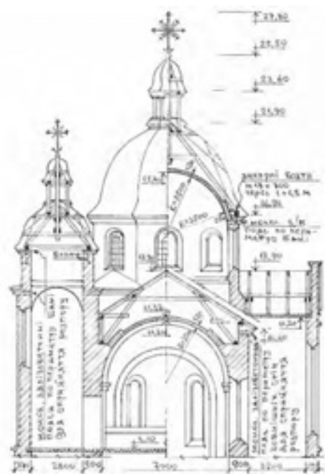
Рисунок 4.12 – Поперечний розріз церкви з цегляними арками і склепіннями
